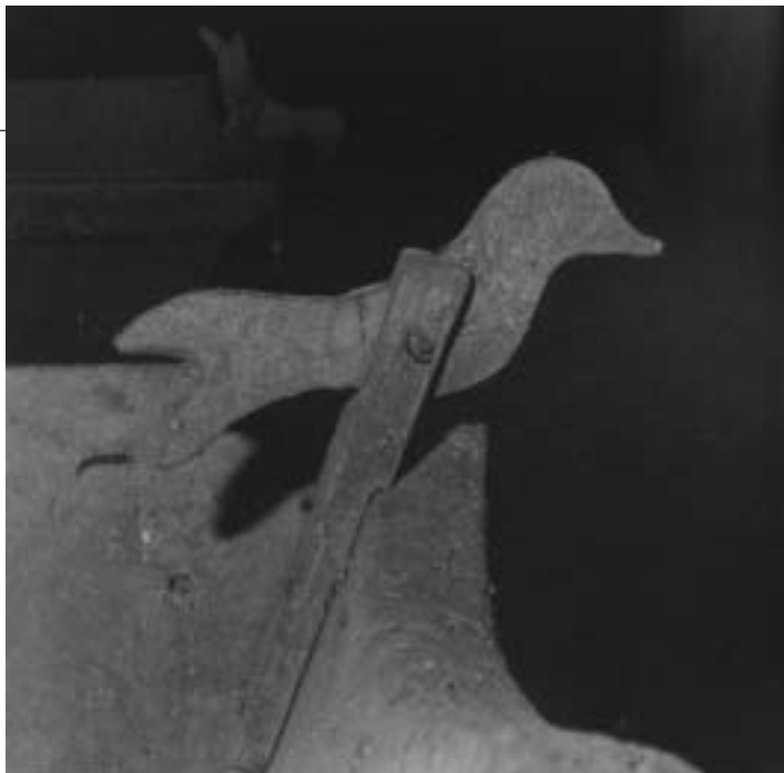
Uccellino di legno e campanella: meccanismo di allarme per evitare lo svuotamento della tramoggia
